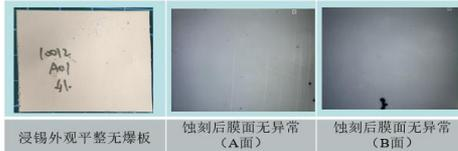
浸锡外观平整无爆板 蚀刻后膜面无异常 (A面) 蚀刻后膜面无异常 (B面)
